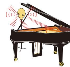
Beim binauralen Sampling der SILENT Piano™ SH-Modelle wird ein Kunstkopf zur Aufnahme genutzt. Auf diese Weise fängt das System den Klang des Yamaha CFX-Konzertflügels exakt so ein, wie der Musiker ihn hört. Beim Spielen im Silent Modus entsteht so der Eindruck, dass der Klang direkt vom Klavier kommt.
